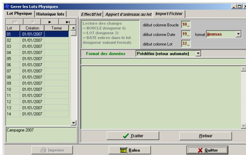
La partie haute affiche les variables à lire et les zones de saisie des informations. La sélection du format «Prédéfini (retour automate)» interdit la modification des zones, la sélection du format «Définition des zones» le permet. Dans ce cas, l'utilisateur doit préciser le format de la date, le programme autorise huit formats de date qui sont proposés sous forme de liste déroulante.
